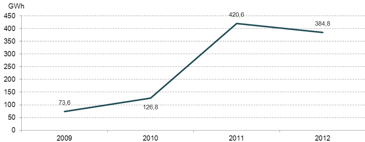
Abbildung 23: Ausfallarbeit verursacht durch EMM in GWh
